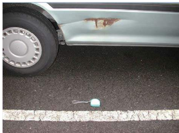
車体衝突凹み
